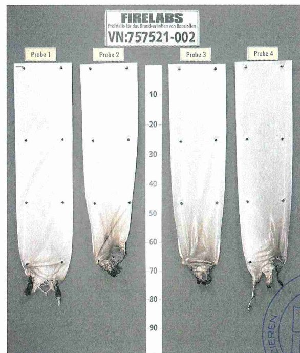
Bild 4 Aussehen des Probekörpers nach dem Brandversuch
